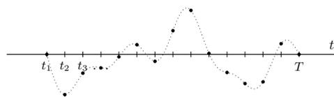
Abb. 2: Durch Vibration verursachte kontinuierliche Auslenkung (gepunktete Kurve) & durch den Sensor gemessene Auslenkungen (Messpunkte) zu den diskreten Zeiten  $t_0, t_1, t_2, \dots, T$
