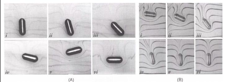
**Abb. 2:** Partikelablagerung ist die Anordnung von Partikeln im freien Fall. Für zylindrische Partikel hängt das Ablagerungsverhalten von der Art des Fluids ab: Im Newton'schen Fall (A) ergibt sich eine horizontale Anordnung, während die Anordnung im nicht-Newton'schen Fall (B) vertikal ist.
