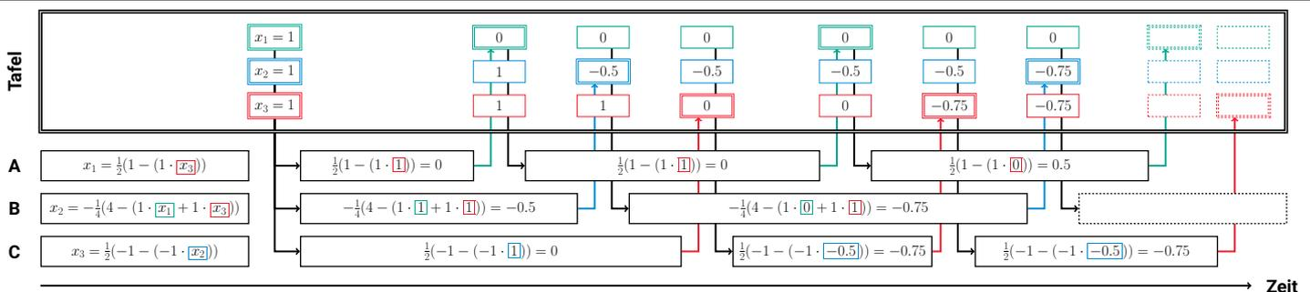
Abb. 2: Zeitlicher Verlauf der ersten Schritte des Jacobi-Verfahrens für das oben genannte Beispiel mit folgender Zuweisung: Person A bekommt Gleichung 1 und Variable  $x_1$  zugewiesen, Person B Gleichung 2 und Variable  $x_2$  und Person C Gleichung 3 und Variable  $x_3$ .
